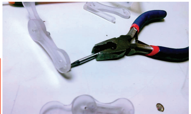
Figura 6. Ensamble del mecanismo de los dedos.
